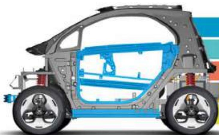
Telaio in acciaio ad alta resistenza
